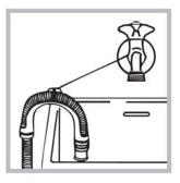
如果排水管導入浴盆或洗滌盆, 將 (隨機配備的)特製塑料件安 上,以使導管頭在排水時保持彎 曲,避免出現移位,建議將其固定 在水龍頭上。
