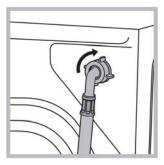
進水軟管的另一端連接本機。只需鬆開接頭配件,轉動軟管並重新 緊固接頭配件,確保不漏水即可 (見圖)。
