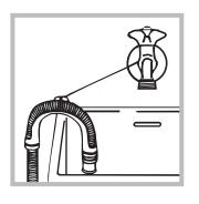
如果將排水管導入浴盆 或洗滌盆,導管末端位 置不能低於水面。
