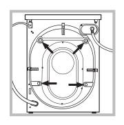
3. 請移除位於本機的背 部的4顆保護螺釘(在 運輸過程中使用)和 帶有墊片的橡膠墊圈 (如圖)。
