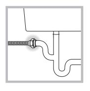
如果將排水管導入洗滌 盆底部,連接前須確保 水管蓋已被移除。
