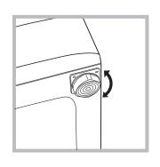
2. 若地板並非處於水平 狀態,通過左右旋轉 可調節機腳(見圖), 使本機水平放置。本 機工作面的坡度不能 超過2度。 正確調平機器能使洗衣乾衣機穩定操作,有助避免振動和過大的噪音,並防止本機在運行時移位。如果將本機放在地毯上,請調整機腳,以便在本機下方留出足夠的通風空間。
