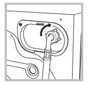
2. 將進水管的另一端連接洗衣乾衣機背部之右上位置。只需鬆開接頭配件,轉動軟管並重新緊固接頭配件,確保不漏水即可(見圖)。
